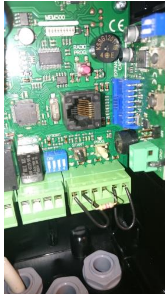
Hovedkort I Styringskap for programmering av motor og sendere
